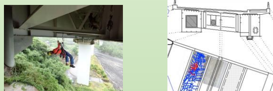
ひび割れ計測による自動図化
